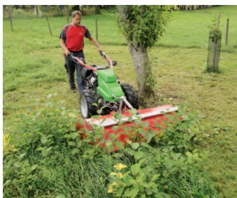
*Rapid Euro avec débroussailleuse à fléaux utilisée pour le mulching*
