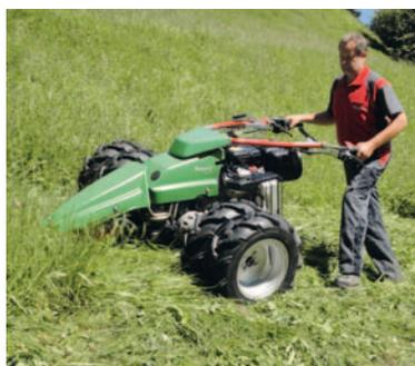
Vous configurez la Rapid EURO pour vos besoins spécifiques. Le modèle EURO 3 est basé sur une transmission hydrostatique avec différentiel tandis que sur l'EURO 4, une direction active hydraulique complète la base. Vous déterminez sur les deux modèles la motorisation, la largeur de l'essieu, les pneumatiques, etc. Ce porte-outils exactement adapté à vos applications permet un travail professionnel tout en optimisant votre budget.
