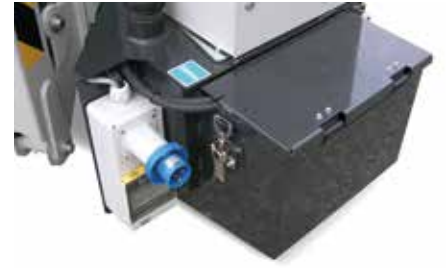
Panneau de commutation magnéto-thermique et entrée de ligne électrique 220 V.
