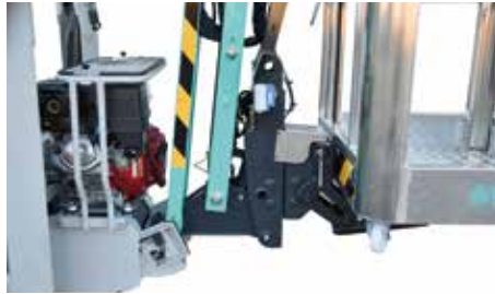
Compacité de l'ensemble flèche recevant le capteur de pesage et le système de montage rapide de la nacelle
