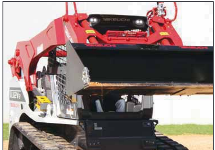
Levée verticale pour plus de stabilité
